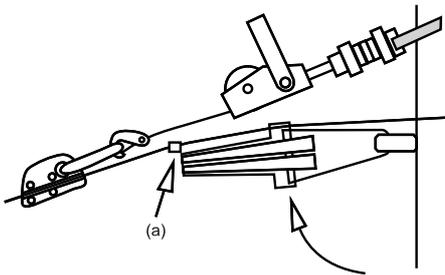
**2.** С помощью инструмента для захвата кабеля и лебедки притяните второй конец к месту крепления кронштейна. После достижения необходимой силы натяжения (которую рекомендуется контролировать с помощью динамометра), поднесите зажим к кабелю, натянув крепежный тросик, как показано на рисунке и пометьте кабель (a) на уровне узкой части корпуса зажима.
