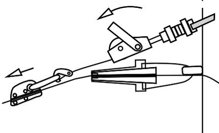
**5.** Освободите кабель от излишнего натяжения и снимите натяжной инструмент.
